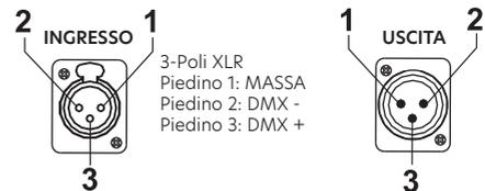
Collegare i dispositivi utilizzando un cavo bipolare schermato a 2 conduttori con connettori XLR maschio-femmina a 3 poli. La connessione dello schermo è il piedino
